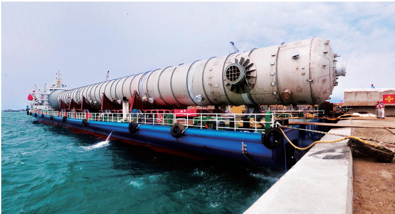
洋浦各部门积极开展“查堵点、破难题、促发展”活动，化“堵点”为“亮点”，促进经济高质量发展。近日，长90米、塔体最大直径8.8米、净重560吨的不锈钢材质乙烯塔从货轮上转运到海南炼化100万吨乙烯项目建设工地，整个项目即将进入生产装置全面安装阶段。林书喜、林鸿冠/摄
