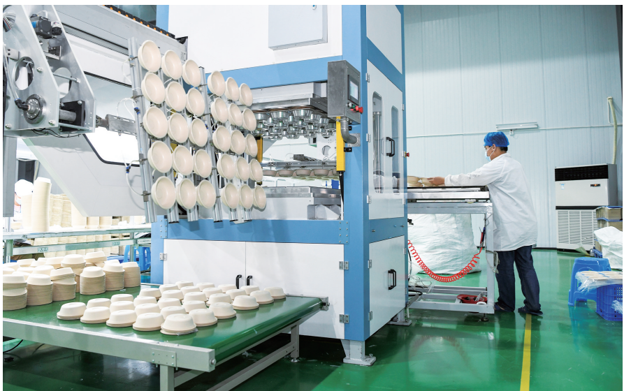
在位于海口国家高新区云龙产业园的海口市裕同环保科技有限公司包装车间,工作人员正在对可降解餐具进行覆膜。苏弼坤/摄
